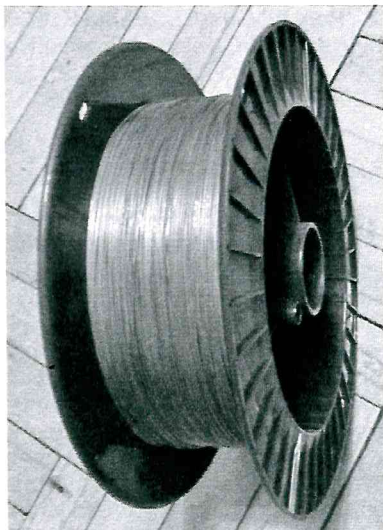
Рис. 4. Внешний вид проволоки \varnothing 0,96 мм из сплава Al-Mg-Sc – ПМ на катушке
