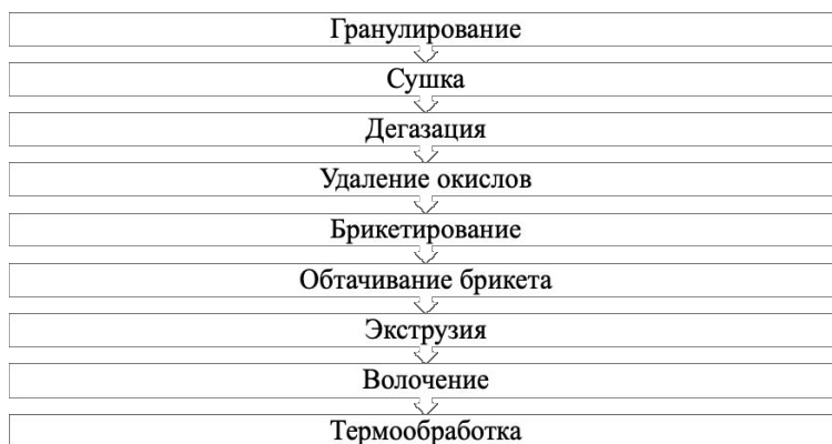
Рис. 1. Технологическая схема получения проволоки из гранул
